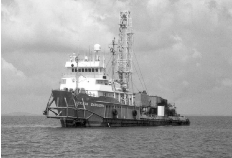
شکل شماره ۳-۱۶: تجهیزات لازم برای آزمایش نفوذ مخروط در سازه های فراهل ساحل
