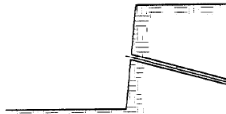
شکل شماره ۴-۳۶: نصب میخ در سوراخ های حفر شده
